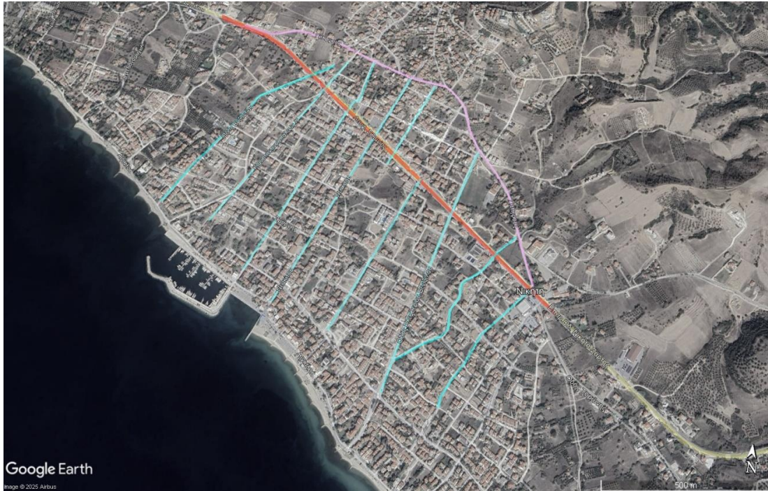
Εικόνα 2: Συμβάλλουσες οδοί στο υπό μελέτη οδικό τμήμα, όπου σε υπόβαθρο Google Earth παρουσιάζονται η κύρια οδός ανάπτυξης των Έργων (κόκκινο χρώμα), οι κάθετες συμβάλλουσες σε αυτήν οδοί (γαλάζιο χρώμα) και η οδός Γαληψούς, παράλληλη, για μεγάλο μήκος της διαδρομής της στον κεντρικό δρόμο της Νικήτης (ροζ χρώμα), με την οποία συμβάλλει στην περιοχή του Super Market Μασούτης
