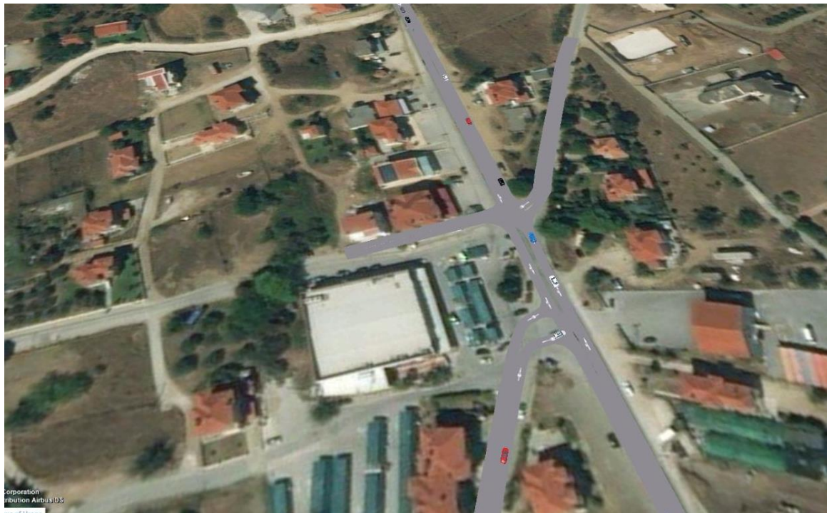
Εικόνα 14: Προσομοίωση υφιστάμενης κατάστασης K4 (VISSIM 3D)
